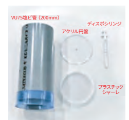
懸濁液噴霧の条件を一定にするために治具を試作。4試験機関に配布している。
